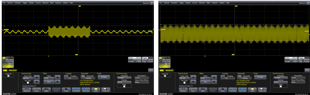
Figure 3-9: mesure de trames CPL Linky en courant – en aval du compteur, avec la charge n°4 « chargeurs / alimentations » - compteur G1 (à gauche) et compteur G3 (à droite)
